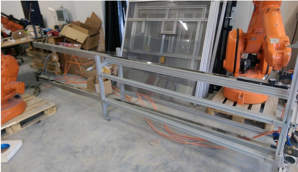
Figur 26 - Transportskenorna med robotar av modell IRB2400 M97A
